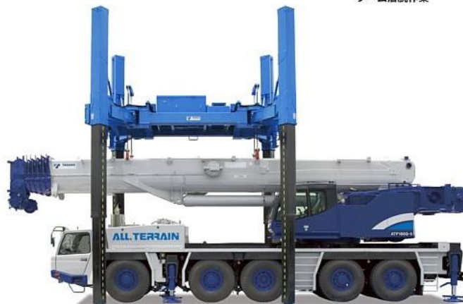
オールテレーンクレーン ブーム着脱作業
